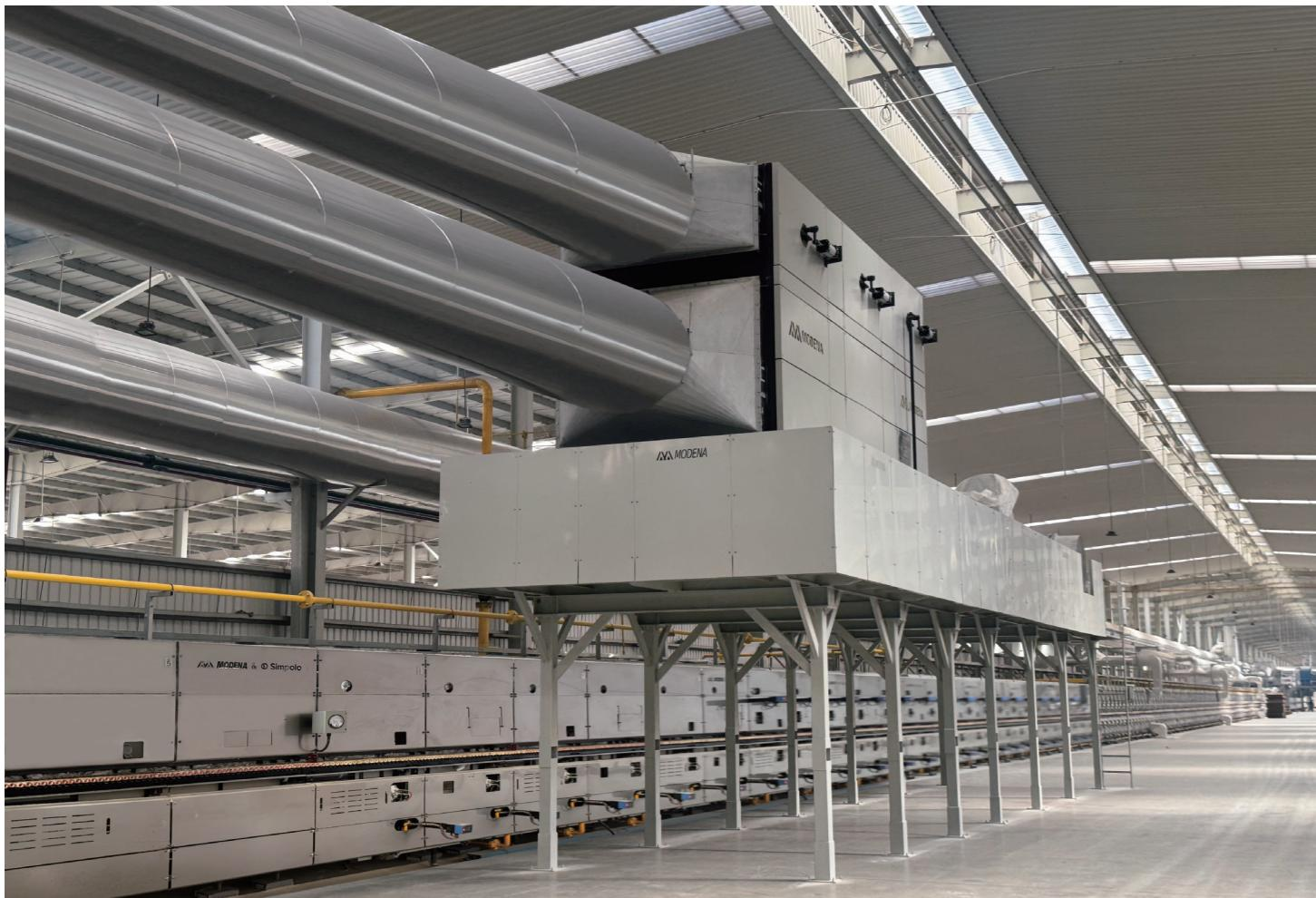
在单线产能持续提升、烧成周期不断缩短的行业背景下，窑炉烟气及尾冷系统所携带的余热总量显著增加。与此同时，高品质瓷砖装饰工艺向精细化与高端化发展，多层釉料与熔块复合应用，使釉线对热风的用量及供热点数量同步上升，对回收热风的稳定性与智能化分配提出了更高要求。
